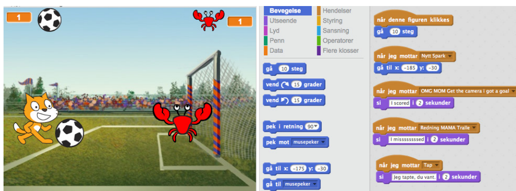
Figur 4: Scratch-program der flere variabler er avgjørende for spillets funksjonalitet og vanskelighetsgrad 22
